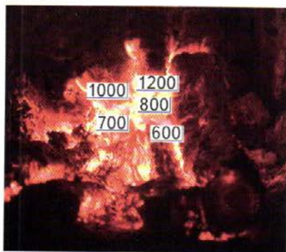
Рис. Ц-23. Яркость и цвет свечения углей в печи зависит от их температуры
