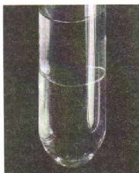
Рис. 21. Вода не смешивается с гексаном. Гексан легче, он плавают на поверхности воды
