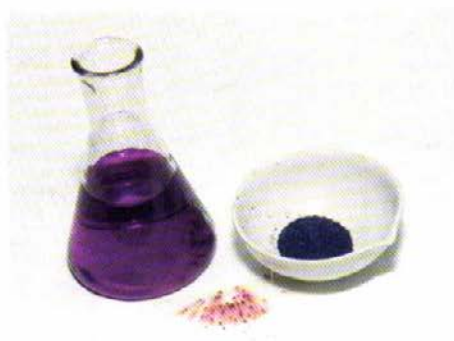
Рис. Ц-14. Раствор \text{KMnO}_4 (слева), твёрдый \text{KMnO}_4 (справа) и кристаллы \text{KMnO}_4 , попавшие на мокрую бумагу (в центре). \text{KMnO}_4 реагирует с мокрой бумагой с образованием чёрного \text{MnO}_2
