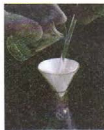
Рис. 34. Фильтр должен прилипнуть к воронке
