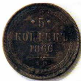
Рис. Ц-31. Чёрный налёт CuO на поверхности старой медной монеты. Оксид CuO образовался из-за длительного контакта с воздухом
