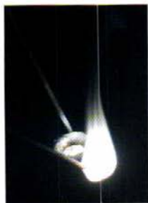
Рис. Ц-26. Горение магния на воздухе. Белый дым — оксид магния (продукт). Температура горения магния очень высокая, и твёрдый раскалённый оксид ослепительно ярко светится
