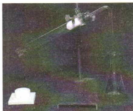
Рис. 57. Разложение перманганата калия и сбор образующегося кислорода
