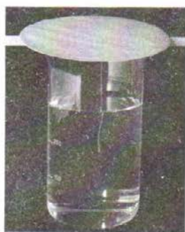
Рис. 22. Нить с узелком в насыщенном растворе. Вместо нити лучше использовать волос
