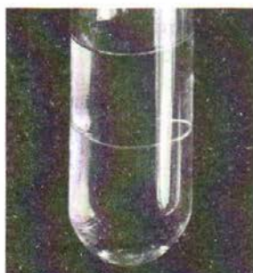
Рис. 77. Вода не смешивается с бензином — между ними видна граница раздела фаз (слой бензина и слой воды). Бензин легче, поэтому при тушении его водой он всплывает и продолжает гореть. Из-за этого горящий бензин нельзя тушить водой
