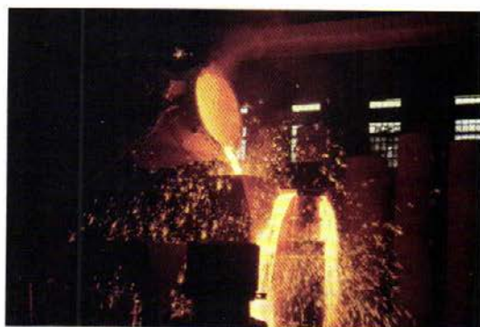
Рис. Ц-24. Расплав чугуна имеет температуру более 1600^{\circ}\text{C} и соответствующим образом светится
