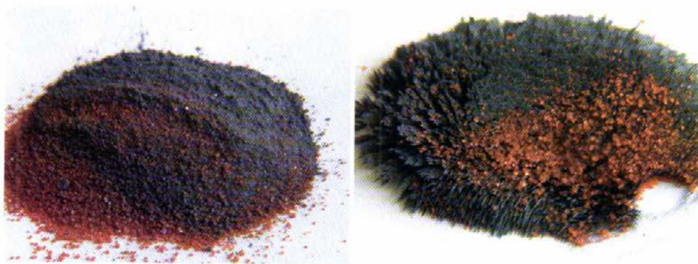
Рис. Ц-11. Слева — смесь железа (серое) и дихромата калия (оранжевый). Справа — та же смесь после попытки разделить её с помощью магнита. Магнит не позволяет полностью отделить железо от дихромата калия: крупинки дихромата цепляются за железную пыль и поднимаются вместе с ней
