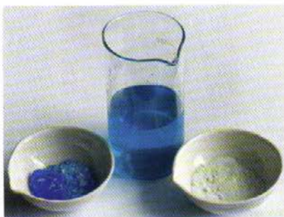
Рис. Ц-47. \text{CuSO}_4 \cdot 5\text{H}_2\text{O} (в чашке слева), безводный \text{CuSO}_4 (в чашке справа) и раствор \text{CuSO}_4 (в стакане)
