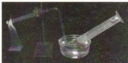
Рис. 69. Установка для получения и сбора газа
