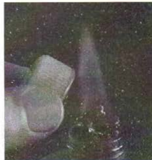
Рис. 5. Горящую спиртовку гасят, накрывая колпачком
