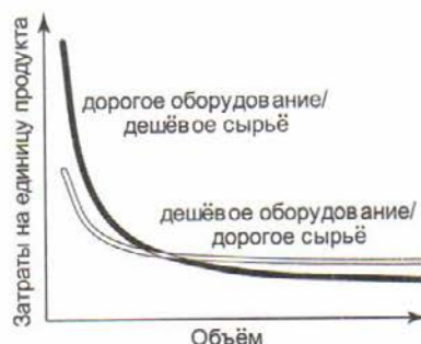
Рис. 56. Затраты на единицу продукции в зависимости от объёма производства при разных технологиях. При объёме, большем, чем в точке пересечения кривых, затраты на дорогое оборудование окупаются за счёт дешевизны сырья
