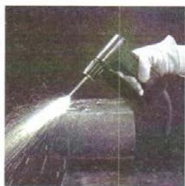
Рис. 54. При газовой сварке и резке металлов используют пламя, в котором ацетилен C_2H_2 горит в чистом кислороде. Температура такого пламени достигает 3000^\circ C
