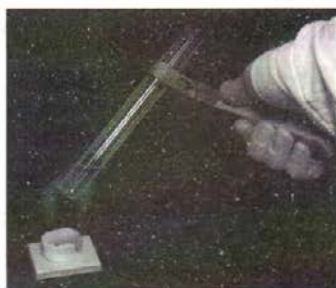
Рис. 7. Так нужно нагревать пробирку
