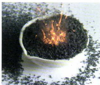
Рис. Ц-2. Разложение (NH_4)_2Cr_2O_7 . Продукт — зелёный порошок Cr_2O_3 (азот и водяные пары при нагревании улетучиваются)
