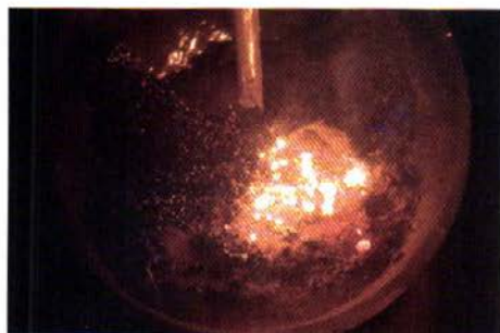
Рис. Ц-32. Горение железа в кислороде. Тонкие железные проволочки берут из «тёрки» для мытья посуды, струю кислорода подают из кислородной подушки через стеклянную трубку. На дно колбы насыпан песок, чтобы стекло не треснуло при контакте с раскалёнными продуктами горения
