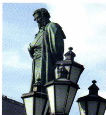
Рис. Ц-19. На воздухе медные изделия медленно покрываются зелёным основным карбонатом меди ( \text{Cu}(\text{OH})_2\text{CO}_3 )
