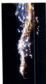
Рис. Ц-28. Горение алюминиевой пудры на воздухе. Благодаря небольшим размерам частицы пудры легко прогреваются, и такой алюминий, имея очень развитую поверхность, быстро реагирует с кислородом воздуха. Раскалённый твёрдый продукт Al_2O_3 ярко светится
