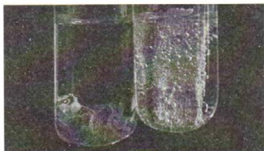
Рис. 28. Цинк квалификации «особо чистый» (слева) реагирует с серной кислотой гораздо медленнее, чем квалификации «чистый» (справа). Пузырьков газа в первом случае гораздо меньше, чем во втором
