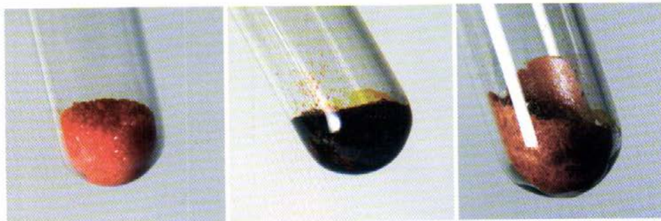
Рис. Ц-7. Кристаллы дихромата калия (слева), его расплав (в центре) и вновь застывшие кристаллы (справа)
