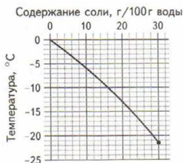
Рис. 20. Температура замерзания раствора NaCl в зависимости от содержания соли
