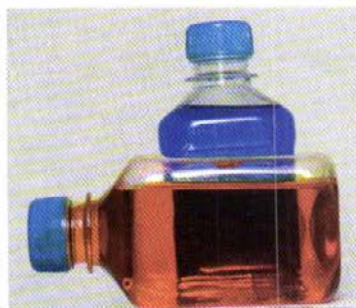
Рис. Ц-58. Оранжевый раствор K_2Cr_2O_7 и синий раствор Cu(NO_3)_2 вместе поглощают почти весь видимый свет. Два этих раствора, поставленные один за другим, кажутся чёрными
