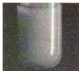
Рис. 53. Каталитическое разложение пероксида водорода в присутствии катализатора — \text{MnO}_2 (взвесь). Выделяется кислород \text{O}_2
