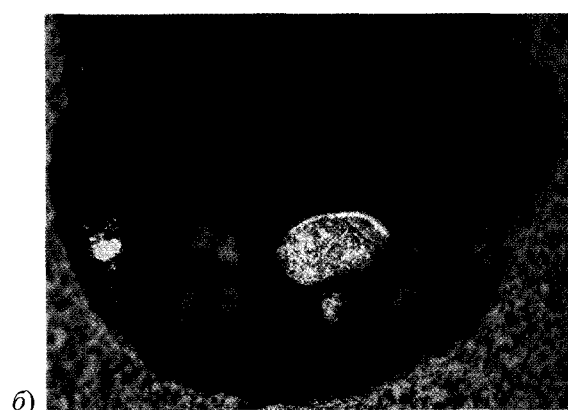
Рис. 5. Эксперимент CS-110. (а) — Распределение фаз по высоте образца после центрифугирования: 1 — пробирка ZrO_2 ; 2 — частичный силикатный расплав (кристаллы оливина + межзерновой расплав ферробазальта); 3 — капли железа; 4 — осевшее железо; (б) — осадок железа
