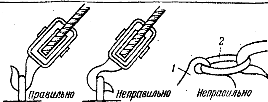
Рис. 40. Закладывание гака за обух и рым:
