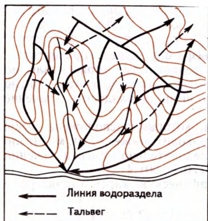
Рис. 51. Нанесение линий водоразделов и тальвегов на рисунок рельефа топографической карты
