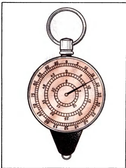
Рис. 17. Курвиметр (отсчеты в километрах)
