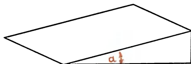
Рис. 100. Подставка для фиксации глобуса в ориентированном положении
