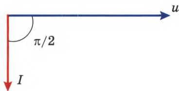
Рис. 42. Векторная диаграмма цепи с ёмкостью
