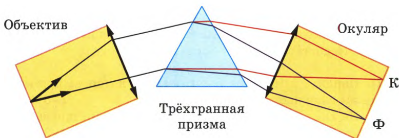
Рис. 155. Устройство спектроסקоп
