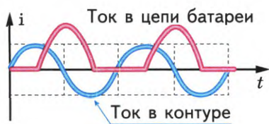
Рис. 62. Схема генератора и график незатухающих колебаний
