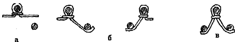
Рис. 43. Петельная структура прессовых переплетений
