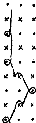
Рис. 121. График двойного комбинированного переплетения (двойное трико и одинарная цепочка)
