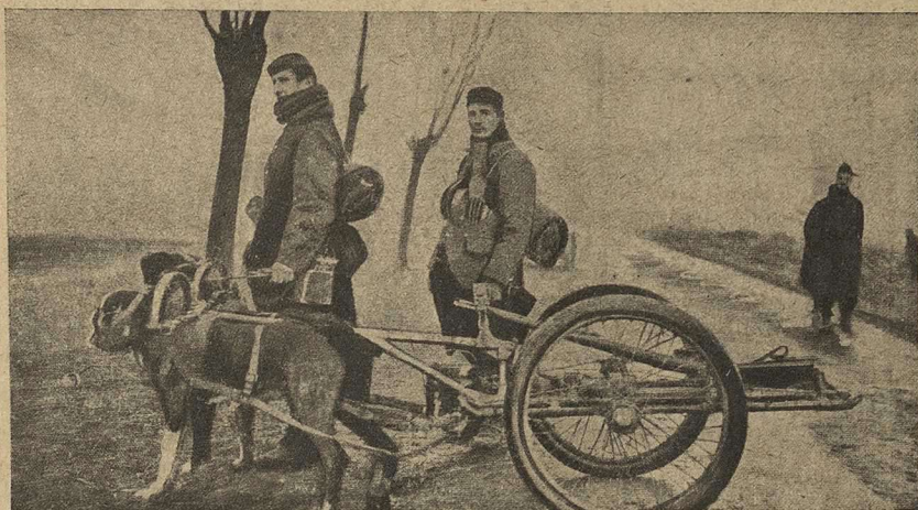
Бельгійскій безпроводный телеграфъ, приспособленный для перевозки на собакахъ.
