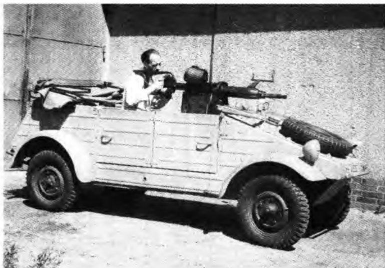
Автомобильная артиллерийская установка на шасси армейского автомобиля «Кюгельбваген» тип 82
