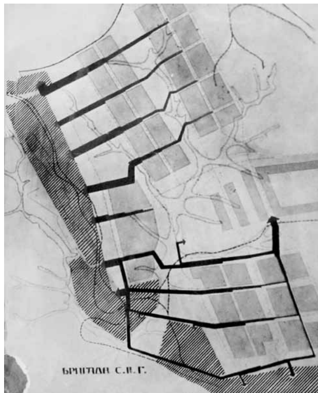
Соцгород Макеевка. Проектно-планировочные схемы, демонстрирующие, каким образом и какой «мощности» потоки рабочих и служащих ежедневно «стекаются» из селитебной зоны к проходным градообразующего промышленного предприятия
