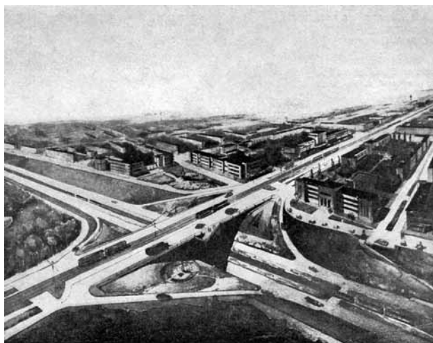
Харьков. Проект пересечения уличной магистрали с автострадой и электрической железной дорогой
