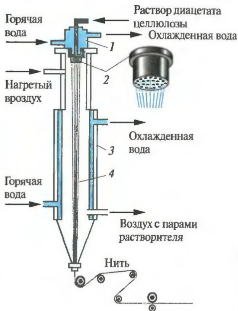
Рис. 62. Схема формования ацетатного волокна:
