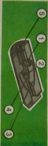
III. Вкладыш: 1 — отражательный выступ; 2 — направляющий паз для направления патрона в патронник; 3 — направляющие скосы, обтекающие подачу патрона в патронник; 4 — выем для досылателя боевой личинки затвора; 5 — навинтованное отверстие для винта спусковой пружины.
