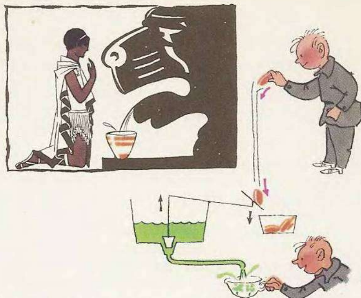
Автомат Герона, продававший «святую» воду. Монета нажимала на рычаг, открывая путь воде.
