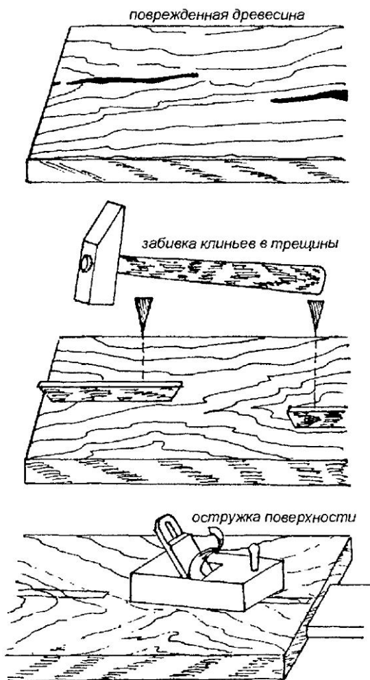
Рис. 8. Заделка трещин
