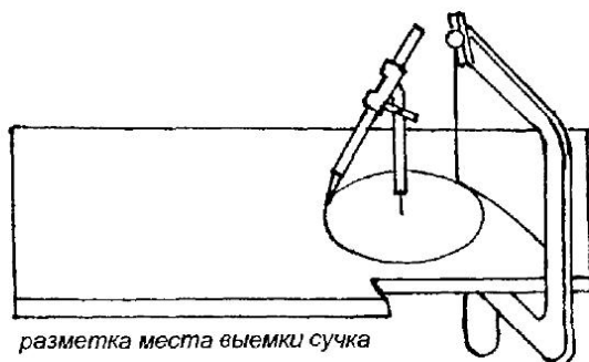
Рис. 9. Заделка сучков
