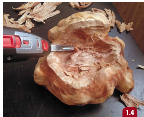
Выборка ямки в заготовке вазы из сувени
