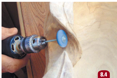
Шлифовка силиконовым кружком
