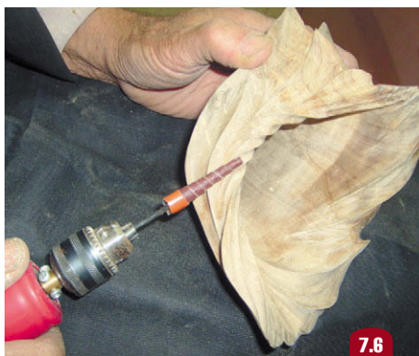
Шлифовка углубления перевязки
