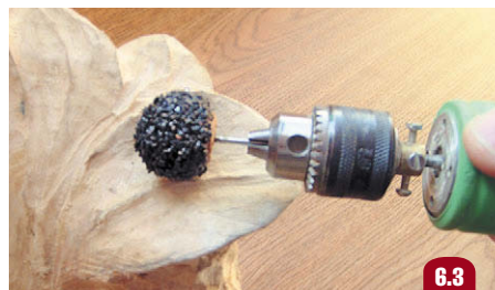
Шлифование шарошкой на пробке
