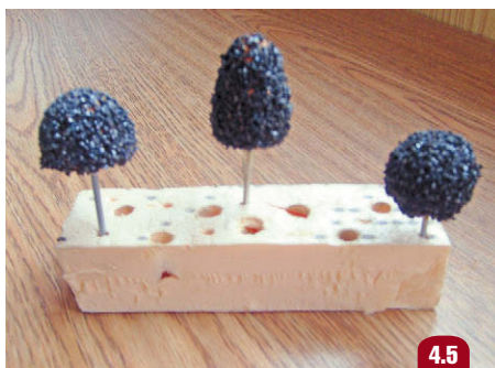
Полуфабрикат шарошек на пробке
