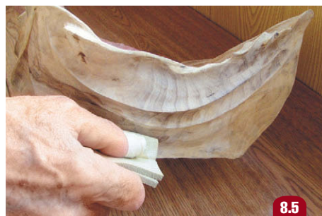
Окончательная шлифовка изделия нетканой губкой
