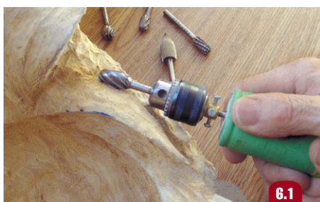
Шлифование конусной фрезой по дереву
