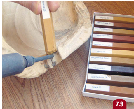
Задельывание царапин и трещин воском
