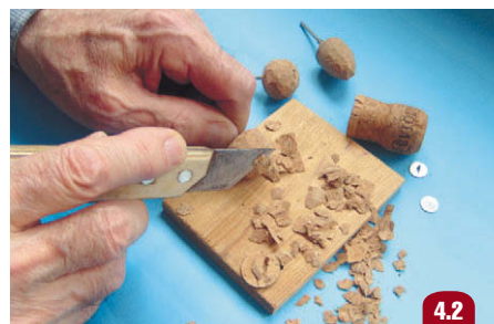
Вырезание заготовки под будущую шарошку
