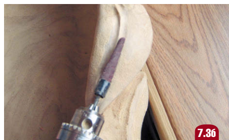
Проработка прожилок на листах: а — шарошкой; б — коническим инструментом на саморезах
