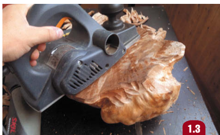
Снятие древесины с низа заготовки
