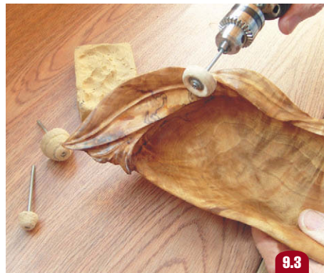
Полировка лака фетровой насадкой
