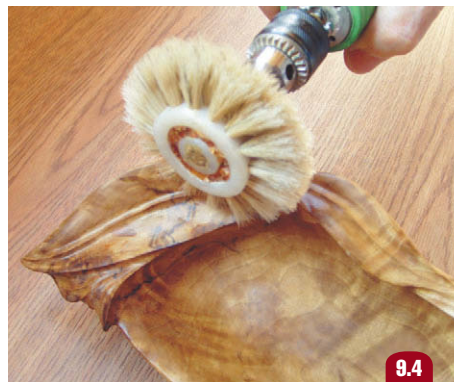
Полировка лака кругом из натуральной щетины
