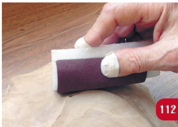
Шлифование шкуркой на пенопласте
