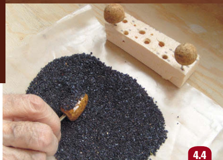
Нанесение абразива на пробковую заготовку
