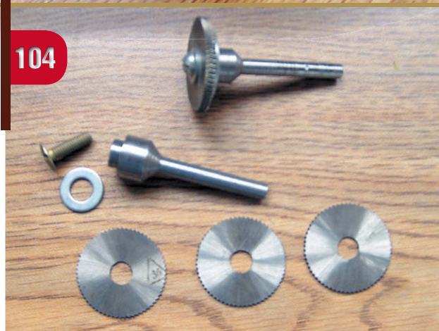
Шарошка из отрезных пил по металлу
