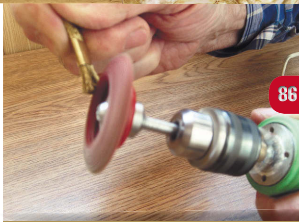
Очистка карбид-вольфрамовой шарошки латунной щеткой
