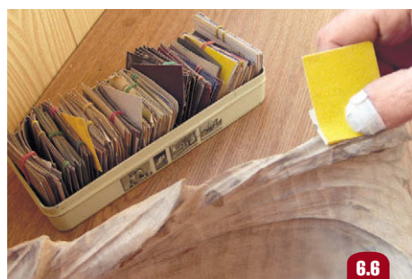
Ручная шлифовка шкуркой с абразивом из граната
