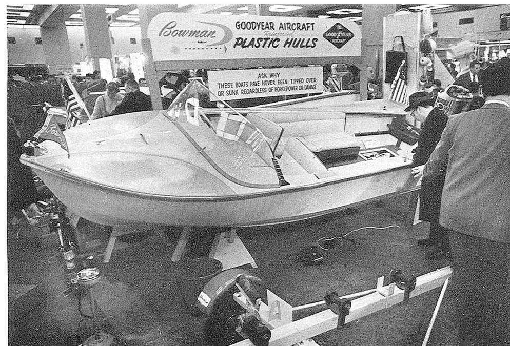
ОСОБО ПРОЧНАЯ ПЛАСТМАССА использована для постройки этого корпуса. Транец из красного дерева. Под деком находится багажное отделение.
